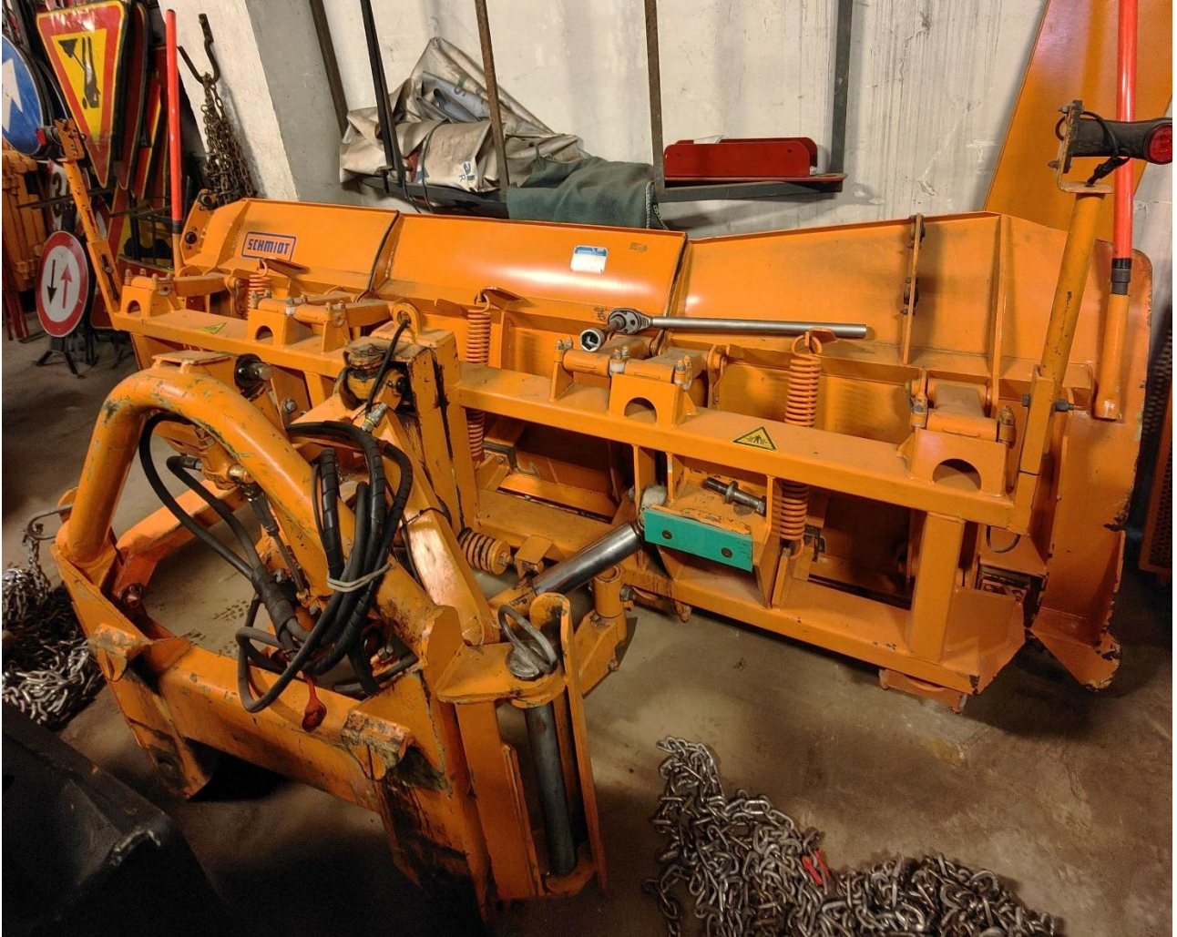
LAMA SGOMBRANEVE marca "Schmidt" tipo MF 2.4 peso 850kg
