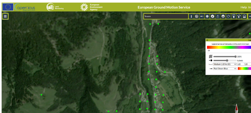
Figura 26: dati interferometrici tratti dal progetto Copernicus. Gli elementi riflettenti non segnalano movimenti nell'area
