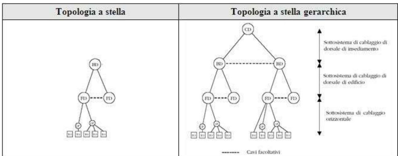
Le figure mostrano i sottosistemi e gli elementi funzionali che costituiscono un sistema di cablaggio strutturato secondo l'architettura definita in CEI EN 50173-1:
