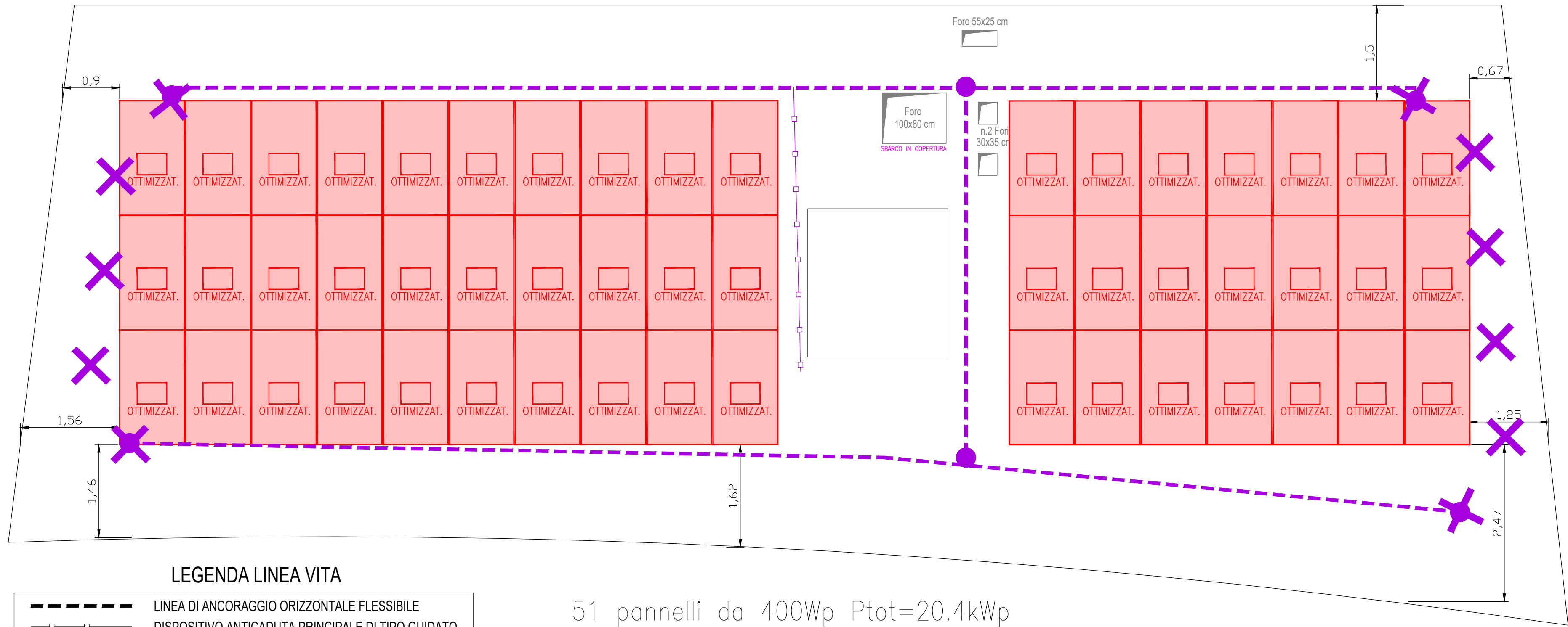
DISPOSIZIONE PANNELLI E LINEA VITA SULLA COPERTURA - SCALA 1:50
