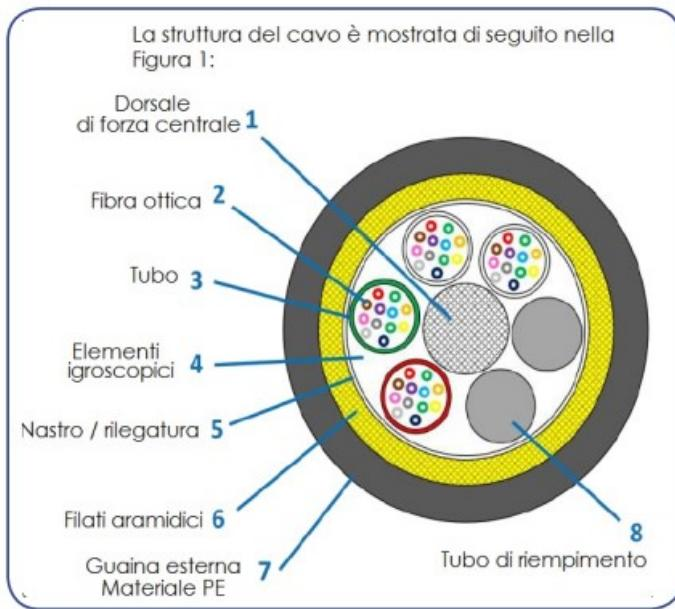
Il cavo è composto da una guaina esterna in polietilene ad alta densità dal colore grigio e resistente ai raggi UV secondo la norma: EN50290-2-24 e ISO 4892-2 2013.
